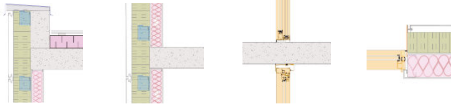
Toiture-mur Plancher intermédiaire Balcon en porte-à-faux Fenêtre-mur
