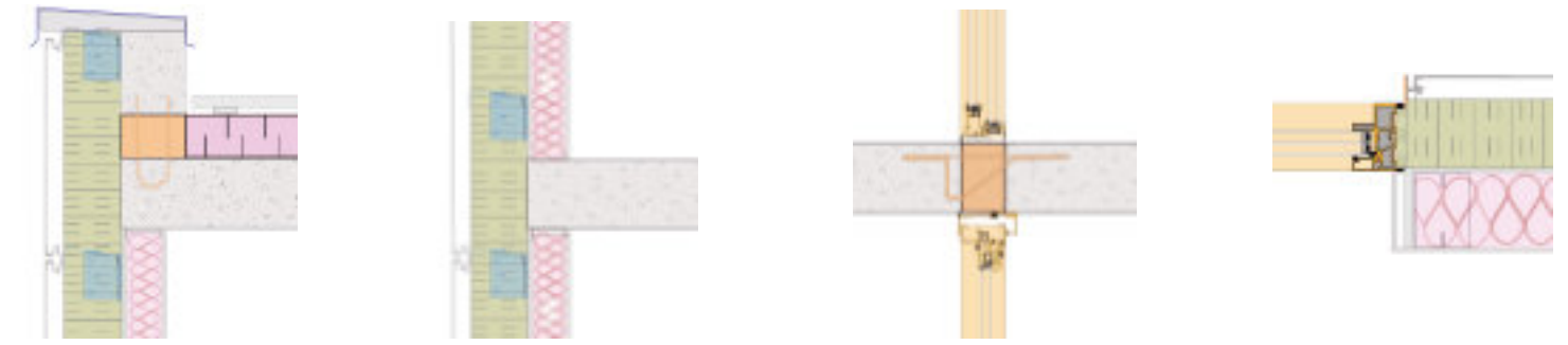
Toiture-mur Plancher intermédiaire Balcon en porte-à-faux Fenêtre-mur
